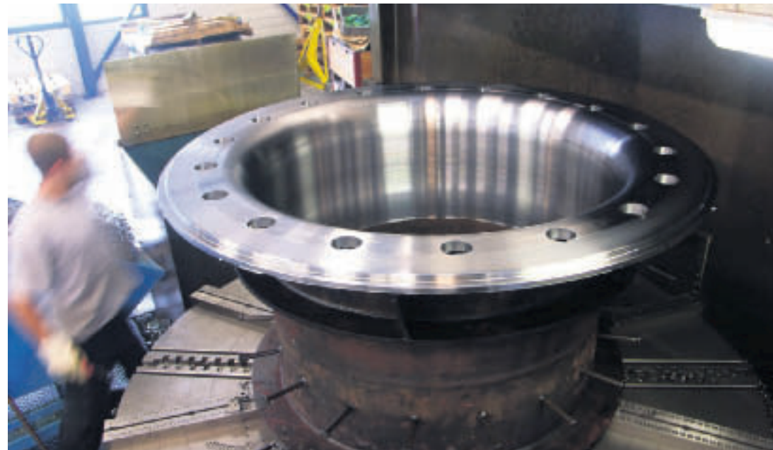
Mit den CNC-Karusselldrehmaschinen werden auch grosse Schweisskonstruktionen und Gussrohlinge bearbeitet.
