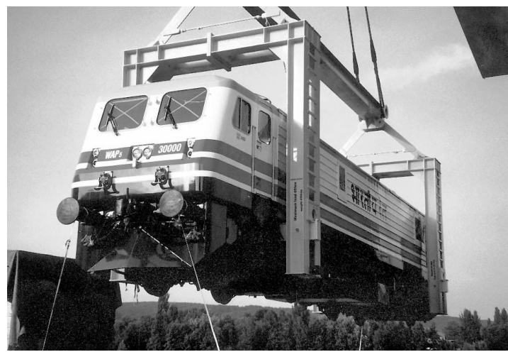
Die Lokomotiven wurden in Basel verschifft und in Indien an Land gebracht, mit Hemag-Verladevorrichtungen.
